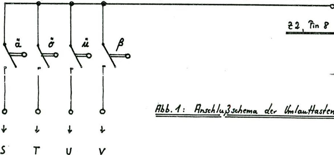
Abb. 1: Anschlußschema der Umlauttasten
