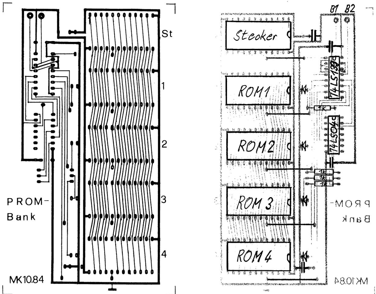
Alle Bauteile befinden sich auf einer einseitig beschichteten Platine. Es sind fünf 24 polige Stecksockel vorgesehen. In den Sockel St wird der Stecker des Flachbandkabels eingesteckt, dessen anderes Ende in den freien Steckplatz des Floppy-Anschlußsteckers eingesteckt wird.
