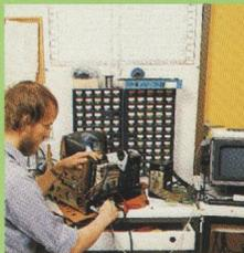
Dieser wird noch durch einen zusätzlichen dreitägigen Burn-in-Zyklus ergänzt. Automatische Testprogramme garantieren, daß dabei alle Funktionen der Geräte angesprochen werden.
