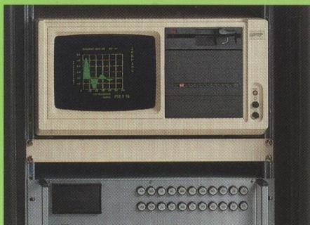
Wahlweise mit 2 Disketten-Laufwerken mit je 616 KB Kapazität oder mit 1 Disketten-Laufwerk und 1 Festplattenlaufwerk mit 17,8 oder 40 MioB Kapazität, ist dieses kompakte Computersystem bestens ausgerichtet zur schnellen Bearbeitung umfangreicher Datenmengen. Alle Voraussetzungen hierzu sind gegeben:
