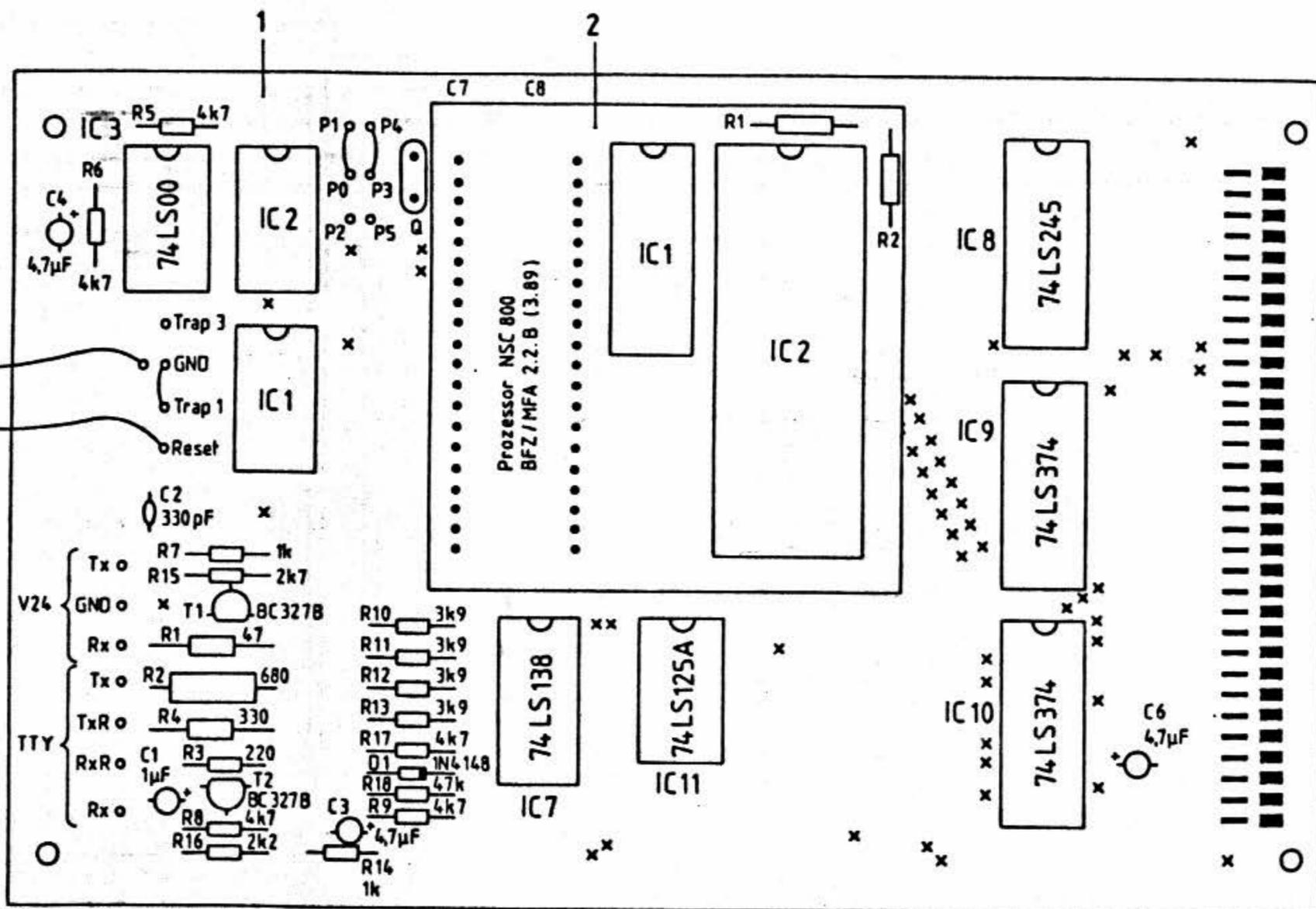
(IC1 und IC2 sind zu entfernen)
