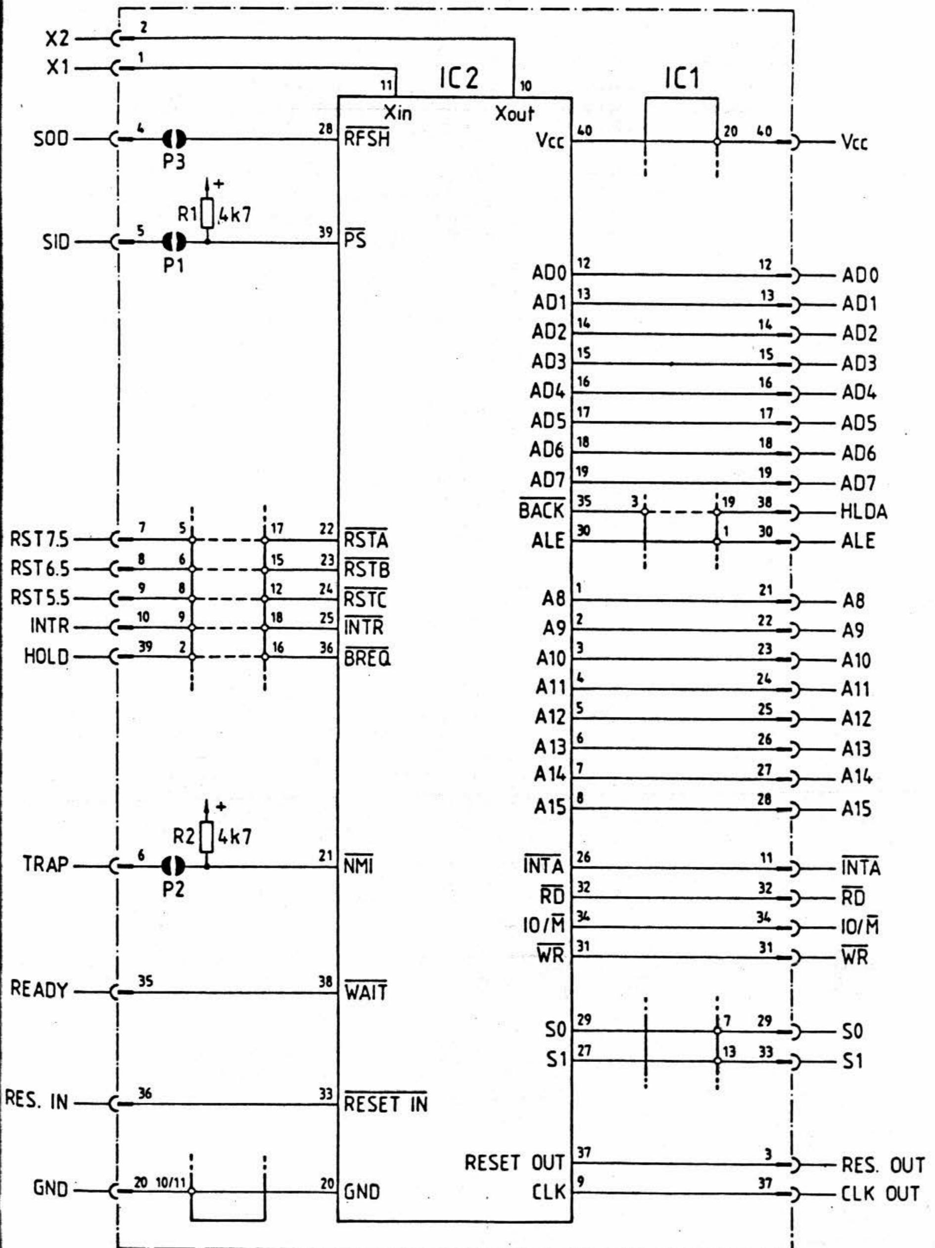
Anhang A1: Stromlaufplan Adapter-Platine
