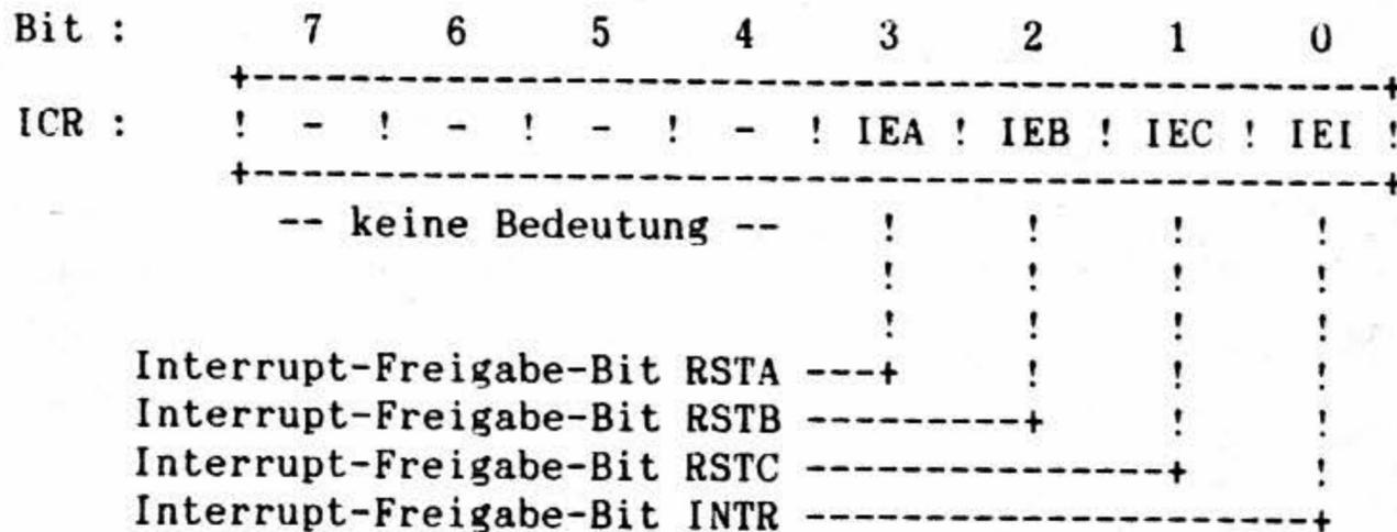
Damit eine Interrupt-Anforderung von der CPU angenommen werden kann, muß das zugehörige Freigabe-Bit gesetzt ( = 1 ) sein. Darüber hinaus müssen Interrupts über den Befehl Enable Interrupt (EI) freigegeben sein.
