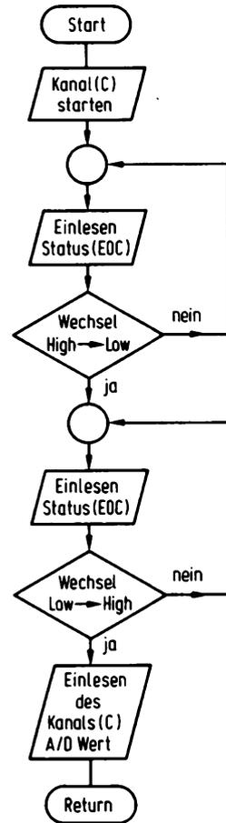
Abb. 1.3.4-5 Assemblerprogramm zur Meßdatenerfassung
