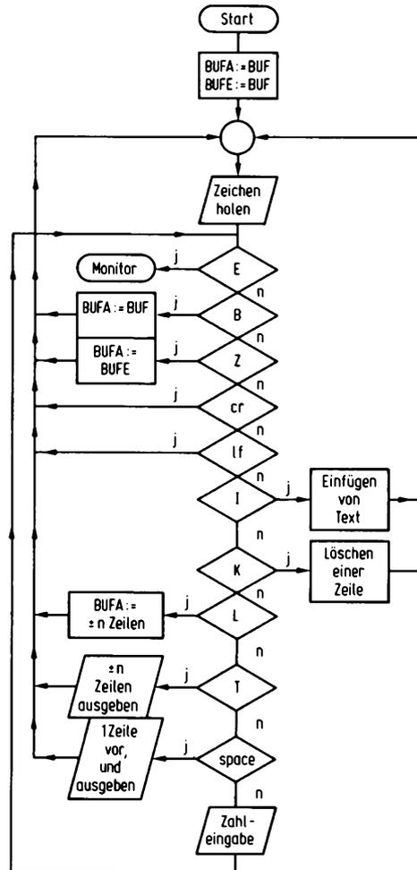
bewirken nichts. I geht zu einem umfangreicheren Teilprogramm INSERT. K löscht eine Zeile und gelangt dazu ebenfalls in ein größeres Teilprogramm. L erhöht BUFA um die entsprechende Anzahl von Bytes, die sich aus der Länge einer Zeile und der Anzahl der Zeilen ergibt. T muß ebenfalls die Länge der Zeilen kennen, um den Text richtig formatiert ausgeben zu können.
