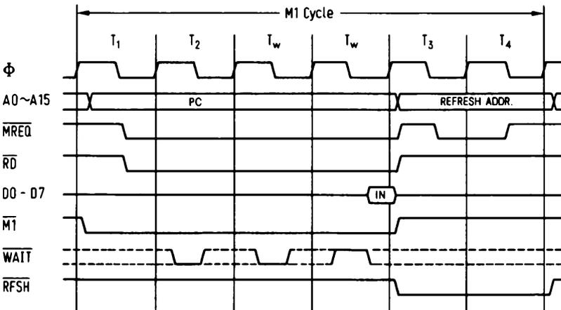
Abb. 1.1.1-6 Befehlsholphase mit Warte-Zyklen
