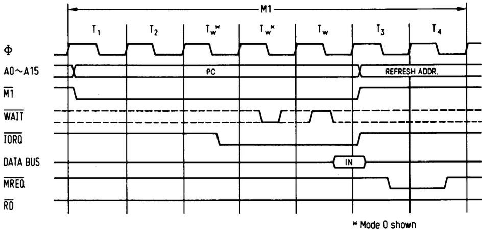
Abb. 1.1.1-14 Interrupt mit zusätzlichen Warte-Zyklen
