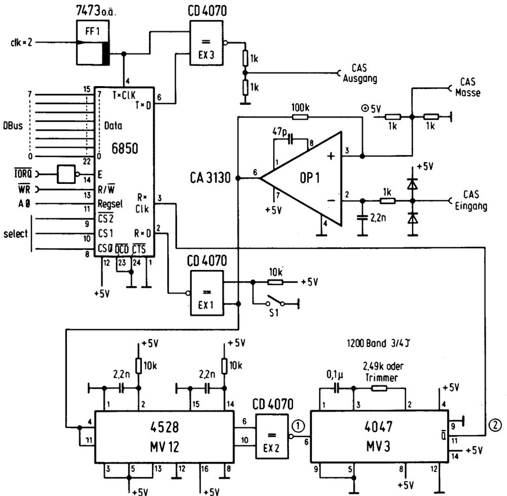
Abb. 1.3.3-2 Schaltung des Kassetteninterface mit PE
