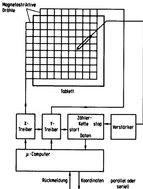
Abb. 1.4.2-1 Blockschaltbild eines Digitalisierers
