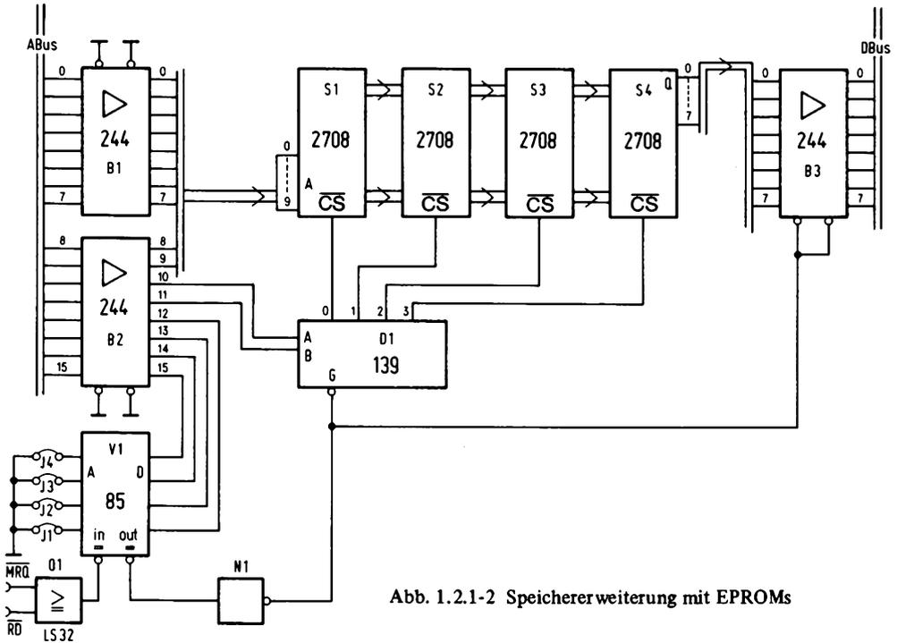
Abb. 1.2.1-2 Speichererweiterung mit EPROMs
