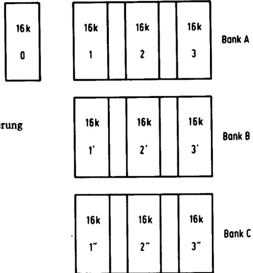
Abb. 1.2.1-3 Einfache Bankselektrealisierung
