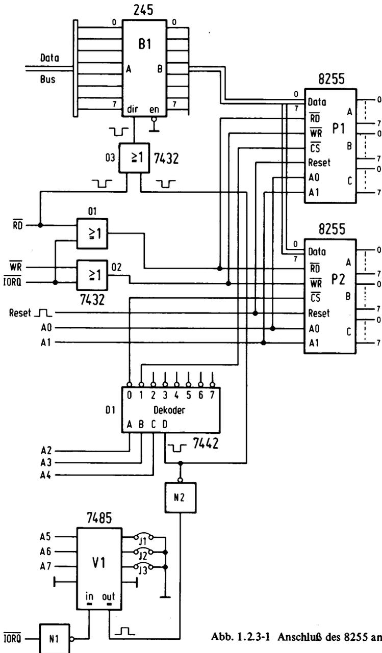
Abb. 1.2.3-1 Anschluß des 8255 an den Z80
