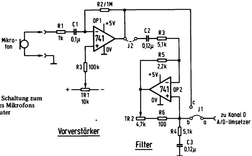
Abb. 1.3.4-8 Schaltung zum Anschluß eines Mikrofons an den Computer
