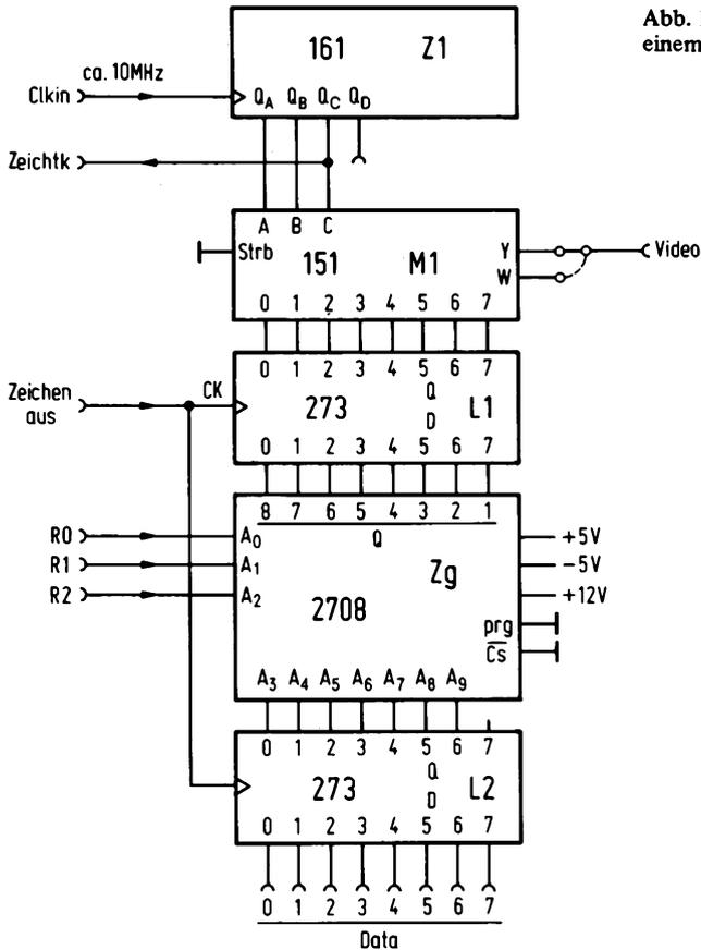
Abb. 1.3.1.2-3 Ansteuerschaltung mit einem Zeichengenerator
