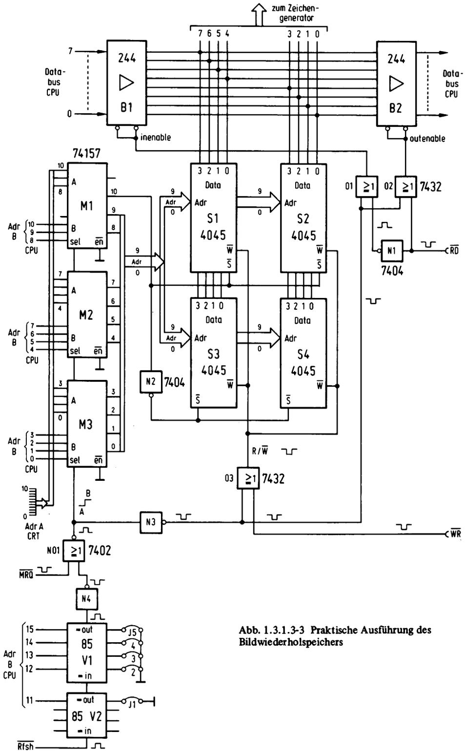
Abb. 1.3.1.3-3 Praktische Ausführung des Bildwiederholerspeichers
