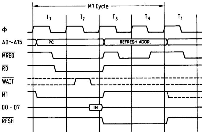
Abb. 1.1.1-5 Impulsdiagramm der Befehlsholphase
