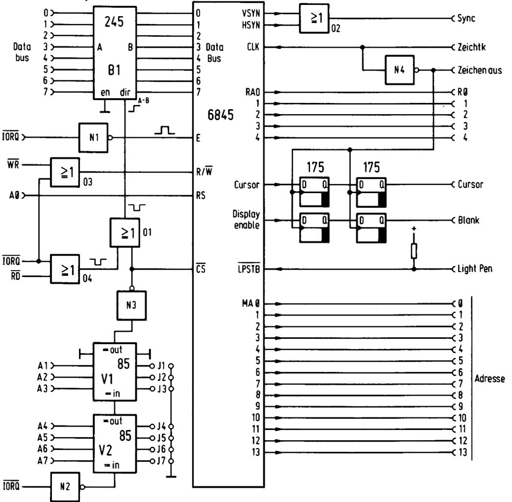
Abb. 1.3.1.1-6 Anschluß des 6845 an den Z80
