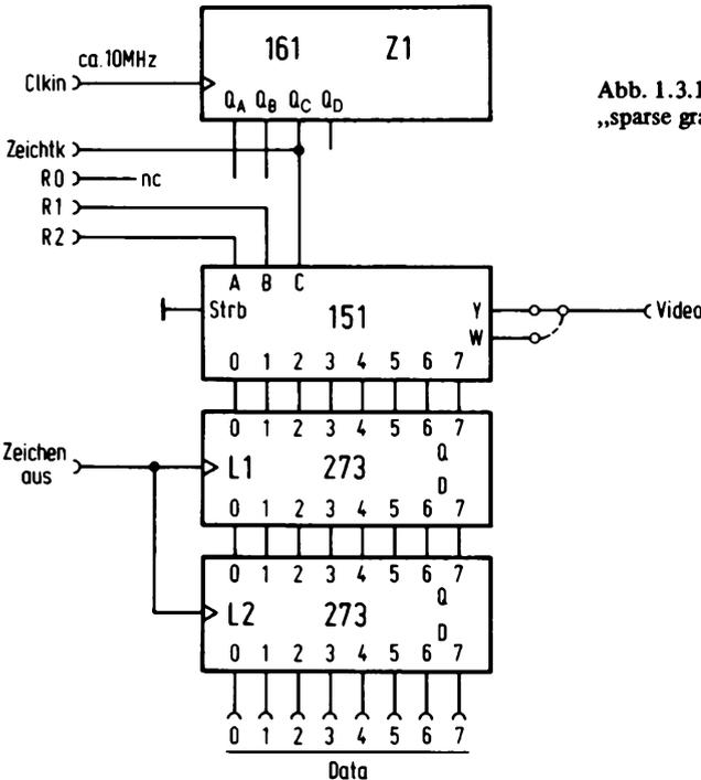
Abb. 1.3.1.2-5 Schaltung zur Erzeugung von „sparse graphic“
