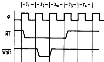
beliebig kleinen Taktfrequenz gearbeitet werden, nur darf der Takt nicht mehr symmetrisch sein, da laut Datenblatt die Taktpulse im Low-Zustand nur 2  $\mu$ s lang sein darf. Die Verweilzeit im High-Zustand darf hingegen beliebig groß sein (wird aber nicht bei allen Herstellern garantiert). Die Reset-Leitung kann mit dem Ausgang des Gatters N2 in Abb. 1.1.1-17 verbunden werden.
