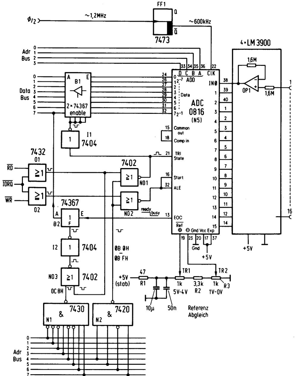
Abb. 1.3.4-3 Anschluß des ADC 0816 an den Z80
