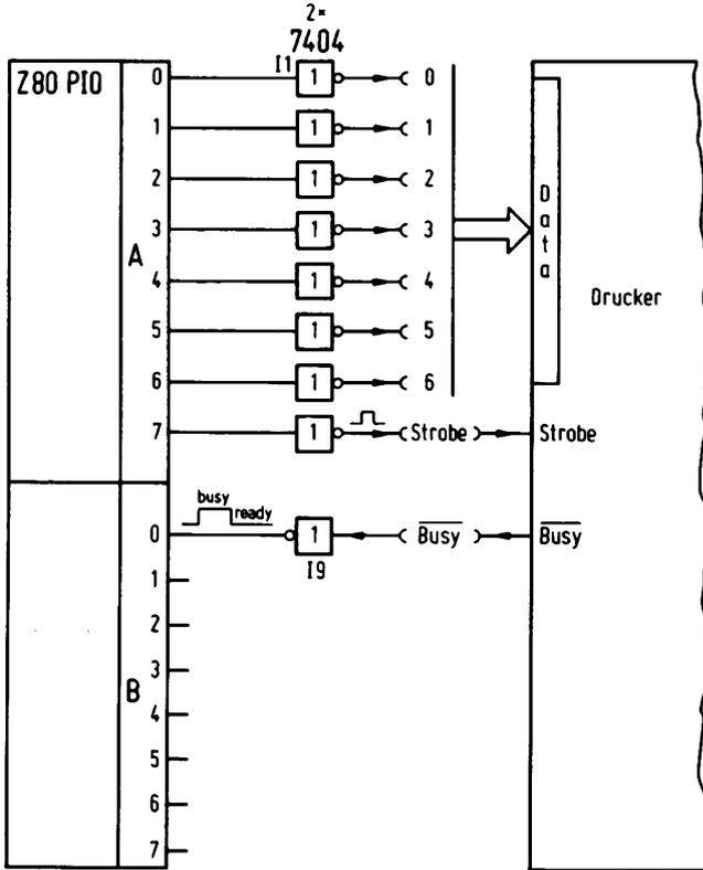
Abb. 1.3.2.1-1 Paralleldruckeranschluß
