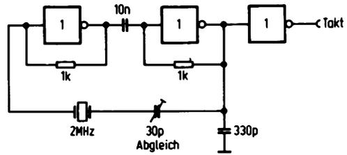
Anstelle des 2-MHz-Quarzes kann hier auch ein 2,5- oder 4-MHz-Quarz verwendet werden, doch dann werden Speicher benötigt, die eine Zugriffszeit kleiner als 450 ns besitzen, oder es müssen WAIT-Zyklen eingefügt werden.
