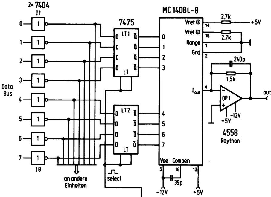
Abb. 1.3.5-1 Schaltung eines D/A-Umsetzers mit dem MC 1408
