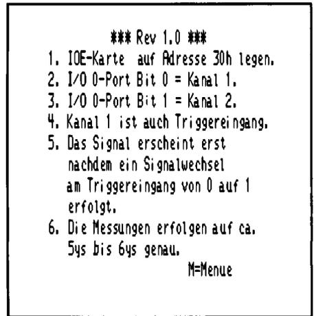
Abb. 7.2.7 Die Kurzerklärung der Funktionen im EPROM
