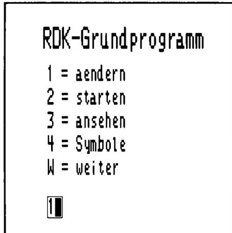
Abb. 6.1.6 Das Grundmenü. Es bietet Ihnen eine Auswahl von Kommandos an, die Sie jetzt dem Computer geben können. Die zugehörigen Aktionen sind im Grundprogramm fest eingebaut. Sie werden dazu benötigt, daß Sie mit dem Computer bequem umgehen können
